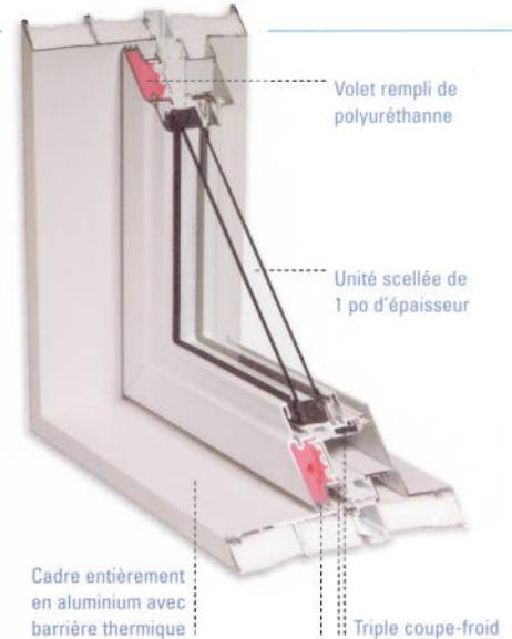
Nous utilisons des scellants extérieurs exclusifs qui offrent une protection accrue contre les infiltrations d'air et d'eau, en plus de conférer une allure très esthétique au cadre. Notre barrière thermique multichambre, entre les cadres intérieur et extérieur, renforce le tout, en plus d'accroître l'efficacité énergétique.
